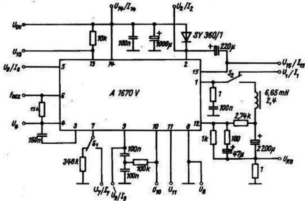
Bild 3: Meßschaltung (typische Einsatzschaltung)
