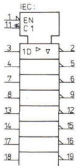
Bild 23: Anschlußbelegung und Schaltzeichen U 74 HCT 533 DK (Bauform: 3)
