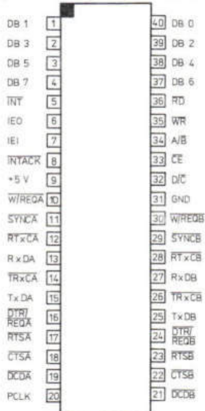
Bild 1: Anschlußbelegung U 82530 DC
