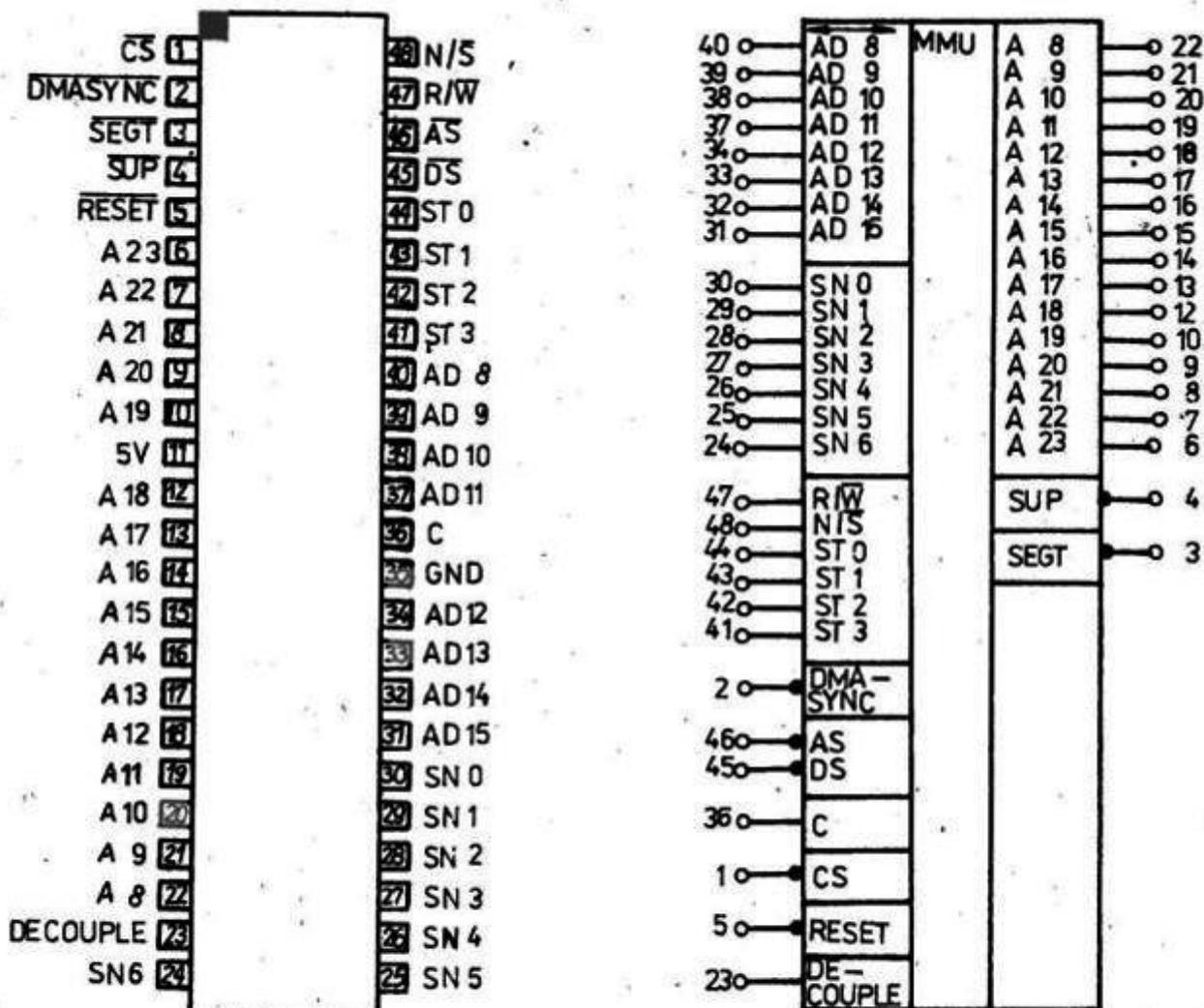
Bild 1: Anschlußbelegung und Schaltungskurzzeichen
